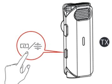
Der Empfänger verfügt über die drei Lautstärkeeinstellungen Niedrig, Mittel und Hoch. Der Lautstärkepegel des Geräts ist standardmäßig auf die mittlere Stufe eingestellt. Möchten Sie den Lautstärkepegel erhöhen/verringern, drücken Sie die sich am Empfänger befindliche **Taste zum Einleiten des Kopplungsvorgangs/Erhöhen des Lautstärkepegels** bzw. die **Taste zum Auswählen der Betriebsart/Verringern des Lautstärkepegels**.
