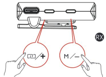
Stellen Sie sicher, dass Sie im **Stereo-Modus** aufnehmen (blaue LED). Halten Sie die **Taste zum Auswählen der Betriebsart/Verringern des Lautstärkepegels** fünf Sekunden lang gedrückt: LED leuchtet grün – Mono-Modus; LED leuchtet blau – Stereo-Modus.
