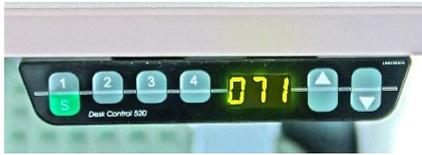
Mit den Pfeiltasten kann der Tisch in der Höhe verstellt werden im Bereich von 62cm bis 127cm. Mit den Tasten 1 bis 4 können vordefinierte Höhen eingestellt werden. Die Taste muss so lange gedrückt werden, bis die Höhe erreicht ist.
